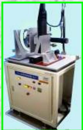
常温用三軸仕様パネルスイッチ用耐久試験機
