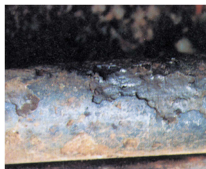
●経過年数：23年 ●管径80A ●腐食状況の所見：錆コブがほぼ全体を覆っており、これを除去したところ漏れが見えられた。
