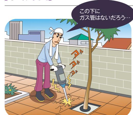
ガス事業者に事前照会を行わず、施工範囲内にはガス管が埋設されていないと思い込んでしまいました。電動工具でコンクリート舗装の壊し作業を行い、誤ってガス管を損傷させたことによります。
