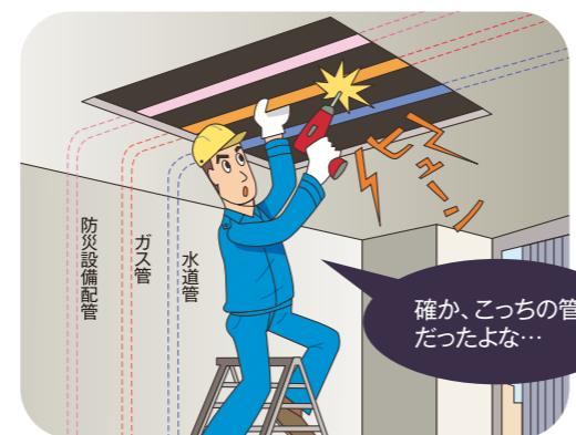
ガス事業者に事前照会を行わず、ガス管と防災設備配管を誤認。また、ガス臭かったにもかかわらず、ガス事業者に通報せず、工事を続けてきました。
